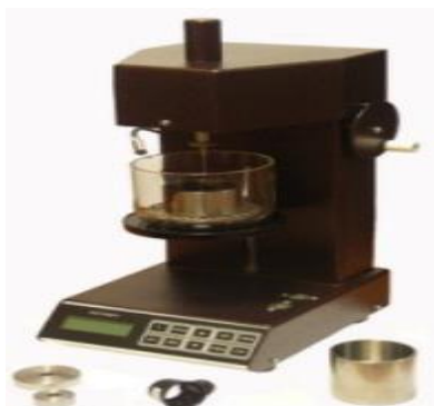
Рисунок 2 . Устройство для определения проникающей способности
