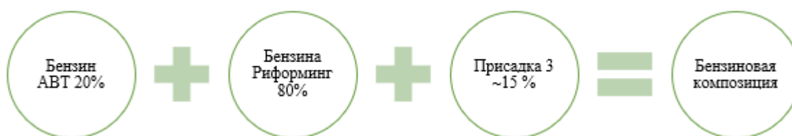
Рисунок 2. Схема приготовления бензиновых композиций
