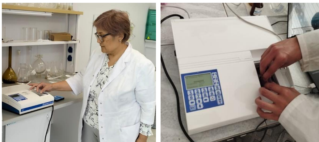
2-сурет. Флюорат-02 судағы мұнай өнімдерін анықтау құралы
