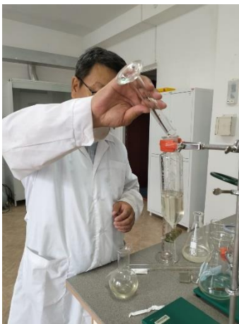
4-сурет. Өндірістік ағынды суларды гексанмен экстракциялау
