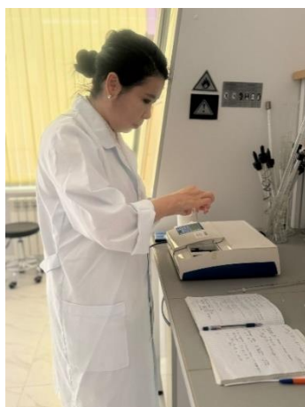
5-сурет. Флюорат-02 құралымен тазаланған судағы мұнай өнімдерін анықтау
